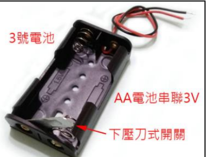
學生認識電池的正極、負極及串接方式
