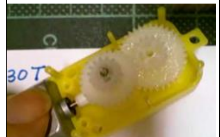
學生認識TT馬達的內部結構與原理
